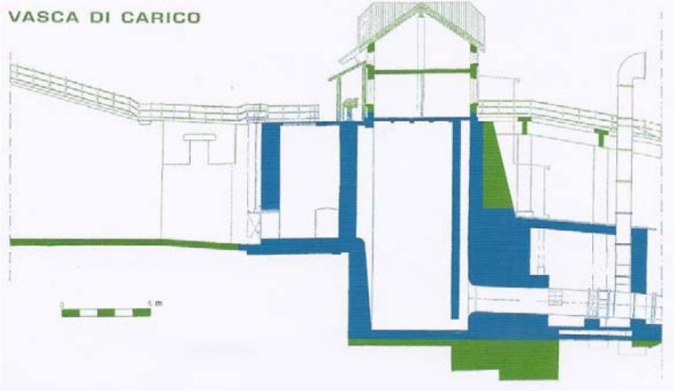
Dalla vasca di carico, con due condotte forzate di circa 1,20m di diametro e dopo un salto di circa 880m, l'acqua viene immessa in pressione nelle turbine della Centrale di Rosone, ove si produce la maggior parte dell'energia elettrica ricavata dal bacino idrografico della Valle Orco, che sottende una superficie di circa 600km quadrati.
